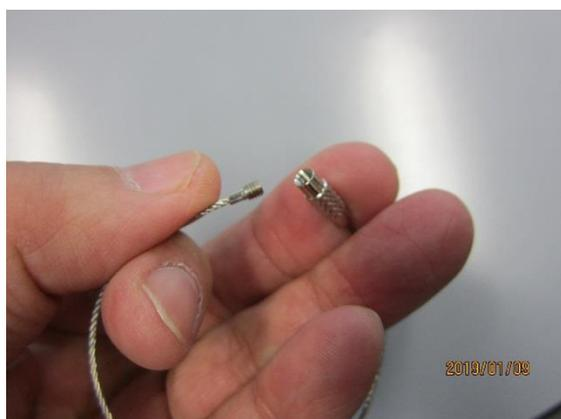
(3) 収縮ポール 2 段目のネジ部の上に、②ワイヤーリングを付けた①マジックテープを巻く。 \*写真参照
