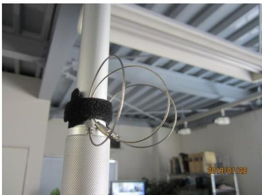
(4) ③ステー用ロープを写真の方向に挿入、アルミ自在金具がロープ (7m) の長さを調整出来るようにもう一方に差込み、結び目が取れないようにする。
