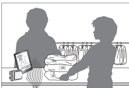
スマートレジ 商品のRFタグを読み取ってタブレット上で会計。
